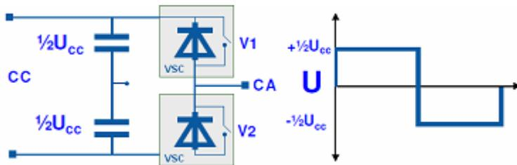
Estos modernos convertidores con tecnología IGBT o convertidores de "fuente de tensión", mantienen una polaridad constante de tensión de CC, y la inversión de potencia se logra no ya por la inversión de la dirección de la corriente. De este modo ya no existen restricciones en la dirección de la corriente, y por lo tanto no hay necesidad de invertir la polaridad cuando se invierte el sentido del flujo de potencia.
