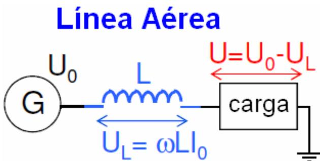
C & L pueden ser compensadas por Reactores / condensadores o mediante el uso de CC, lo que significaría  $\omega = 0$
