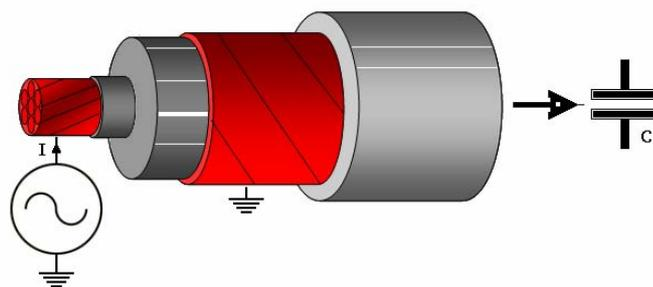
En función a esto, los cables para la transmisión HV-AC, tienen típicamente una capacidad del orden de  $0,2 - 0,3$  [ $\mu\text{F} / \text{km}$ ], y por lo tanto requieren en promedio corrientes capacitivas de  $10$  a  $25$  [A / km], en función de la tensión del sistema y de la frecuencia.
